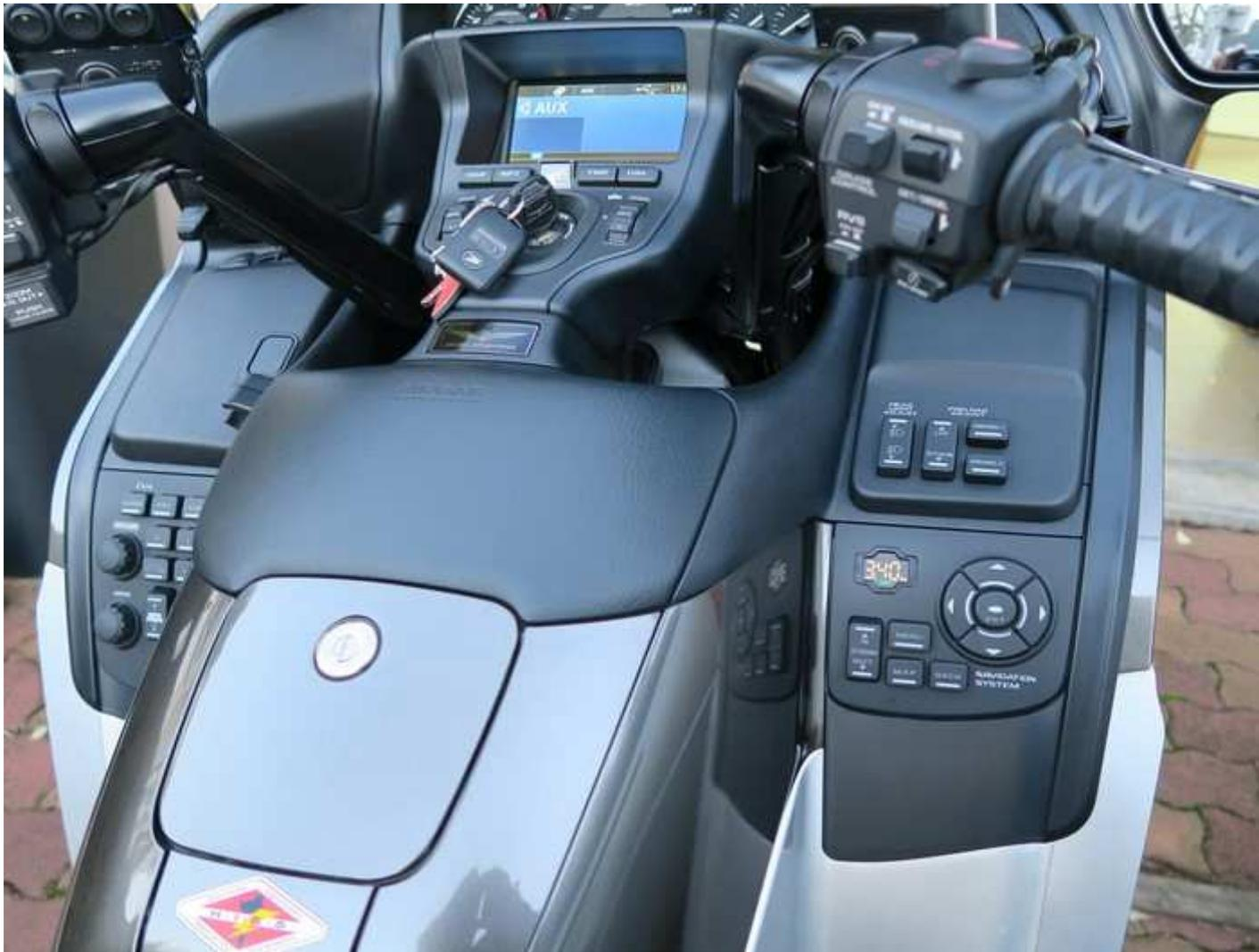
Personnellement j'ai viré le fusible présent sur le fil et tiré une ligne d'alimentation sécurisée venant de la batterie via un relais temporisé ajouté d'un prise double étanche afin de pouvoir enlever le panel pour les travaux de mécaniques à venir.
