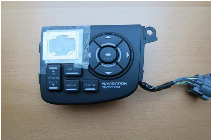
Tracer un gabarit que vous aurez réalisé sur l'écran lui-même, sur une bande adhésive disposée et ajustée sur le panel de droit.
