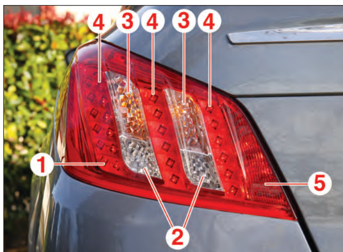
IDENTIFICATION DES AMPOULES SUR UN FEU ARRIÈRE GAUCHE
