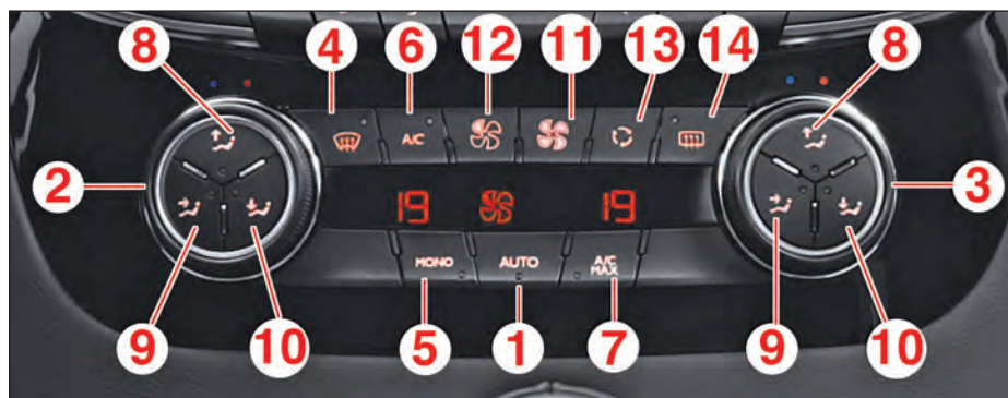
COMMANDE DE CLIMATISATION AUTOMATIQUE
