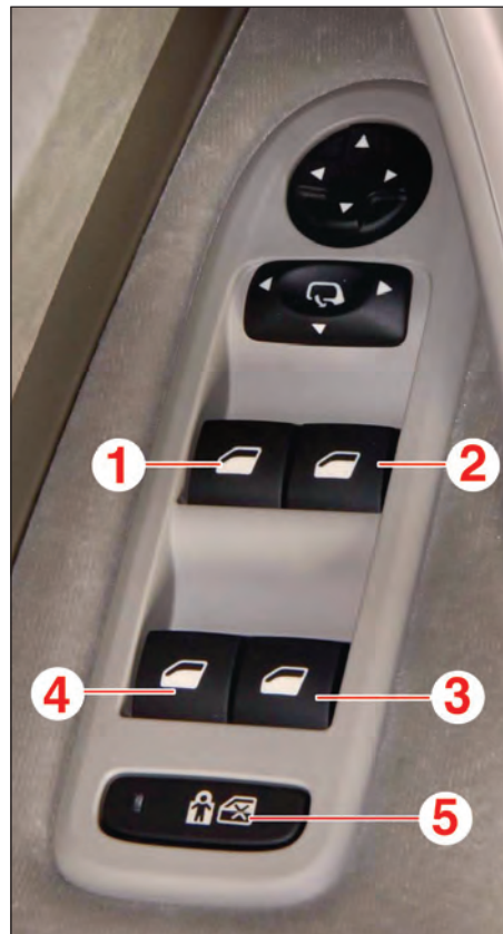
COMMANDE DES LÈVE-VITRES 1. Commande de la vitre du conducteur 2. Commande de la vitre du passager avant 3. Commande de la vitre arrière droite 4. Commande de la vitre arrière gauche 5. Verrouillage des vitres et des portes passagers arrière
